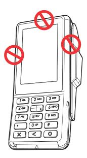
Using an enclosed metal frame or mount may negatively affect contactless performance. L'utilisation d'un cadre métallique fermé ou de montage peut affecter négativement CAUTION contact performance.
